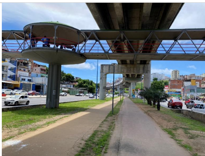
Figura 16 – Dificuldade de acesso na ciclovia da Av. Mário Leal Ferreira (falta de rampa desde a passarela)
