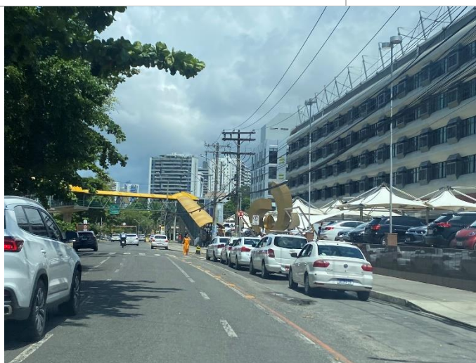
Figura 69 – Ciclofaixa da R. Carlos Gomes (falta um espaço entre a ciclofaixa e o estacionamento dos carros)
