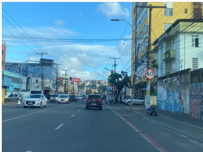
Figura 94 - Ciclovía na Av. Sete de Setembro (largura bidirecional de 1,80m, menor que a largura recomendável de 2,50m)
